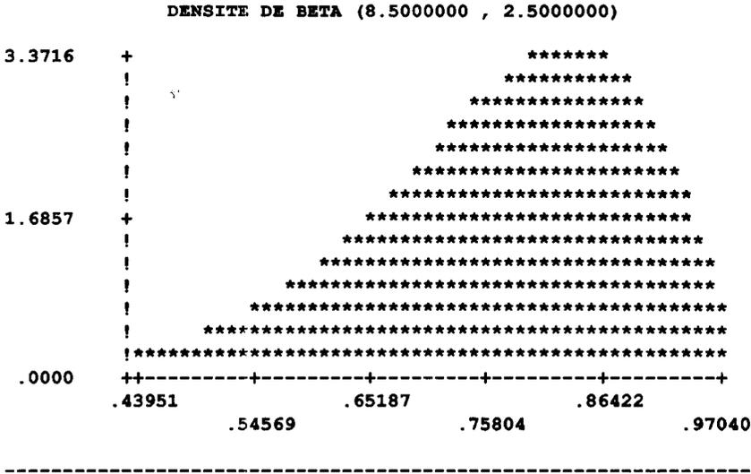
La lecture de cette courbe se fait d'une manière analogue à celle d'une loi normale; la surface lue sous la courbe nous donne la probabilité recherchée. On a en ordonnée la densité de la probabilité (nombre sans dimension) et en abscisse la valeur de la fréquence. Par exemple, si on cherche la probabilité pour que la fréquence de la catégorie examinée soit supérieure à .5, on regarde l'aire de la courbe à droite d'une verticale qui a pour abscisse .5. C'est la figure suivante:
